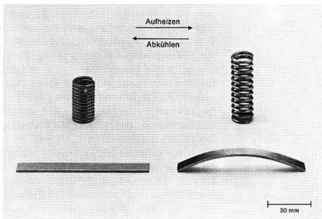
Abb. 3. Druckfeder und Biegestreifen mit Zweiwegeffekt aus einer Cu-Zn-Al-Legierung (A<sub>s</sub> ≈ 65°C, A<sub>i</sub> ≈ 80°C, M<sub>s</sub> ≈ 65°C, M<sub>i</sub> ≈ 50°C).
