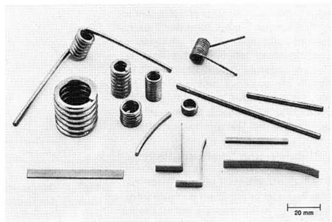
Abb. 4. Beispiele möglicher Ausführungsformen von Memory-Elementen (dargestellt sind sogenannte MEMOTAL-Elemente aus dem Hause G. RAU GmbH & Co., Pforzheim).
